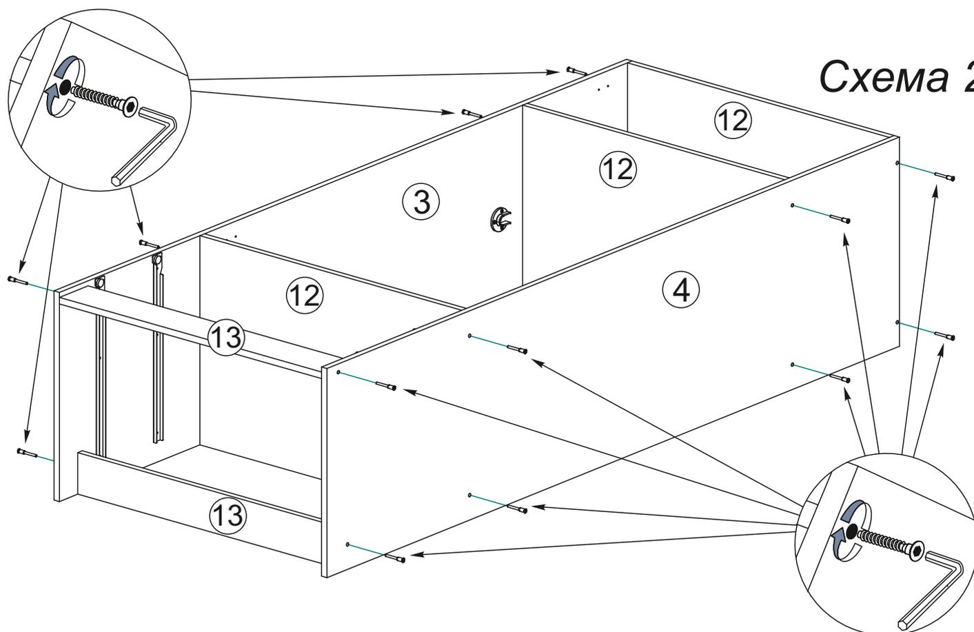
4. Чтобы установить задние стенки (детали №43), необходимо собранную конструкцию перевернуть лицевой стороной вниз. Замерить, с помощью рулетки, и уровнять диагонали ( $a=b$ ). Наложить задние стенки, проложив между ними соединительный брус. Аккуратно, не нарушая диагоналей, прибить ЛДВП гвоздями, шагом 130-150 мм. На торцы боковин №3 и №4 закрепить подпятники, гвоздями 1,6x25, как показано на схеме 3
