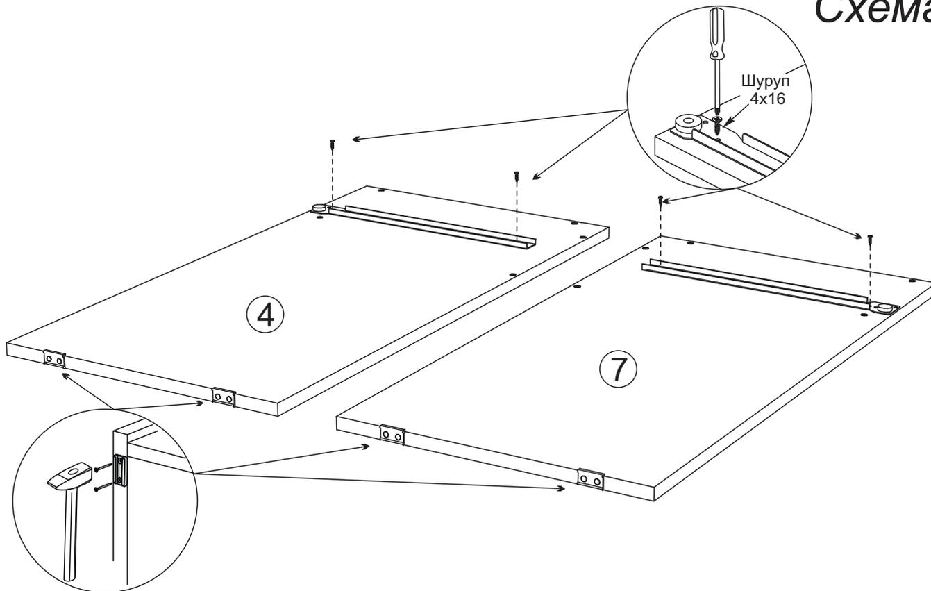
4. Соедините евровинтами боковины №4 и №7 с планками №5 и №11 и вязкой №6. Закрепите крышку №3. Для этого вверните шурупы 4x25 в крышку №3 через планки №5, как показано на схеме 3.
