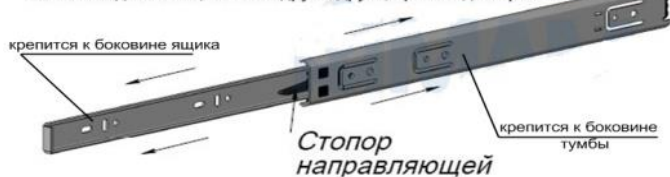
Рис.4 Схема установки шариковых направляющих
