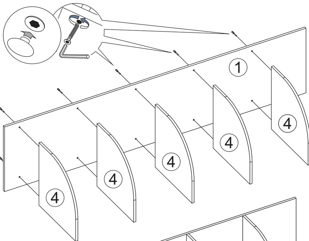
1. Сборка производится горизонтально. Предварительно необходимо отобрать боковины, ориентируясь на сверловку.
