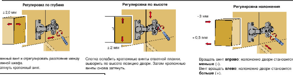
Рис. 1 Схема установки петель
